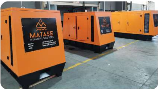
Ndlambe Local Municipality - 20, 40 & 130kVA
